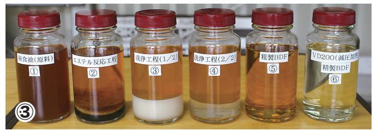
配合比率の検討や機器の動作確認、作業マニュアルの作成などに取り組んだ。廃食油は性状にバラつきがあるため、原料に応じて触媒の配合を変える難しさもある。鈴木氏は「ピーカーテストからスケールアップし、温度調整やアルカリ触媒の配合比率、機械の癖をつかむのに苦労した」と振り返る。
